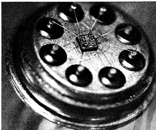
Bild 1. Integrierte Schaltungen werden zunehmend die Empfängertechnik beeinflussen. Operationsverstärker vom Typ TAA 861 und 865 (Siemens)
