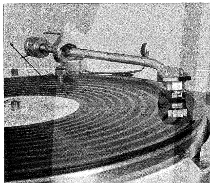
Bild 4. Skatingkraft-Detektor im Shure-SME-Tonarm bei unkompenzierter Skatingkraft
